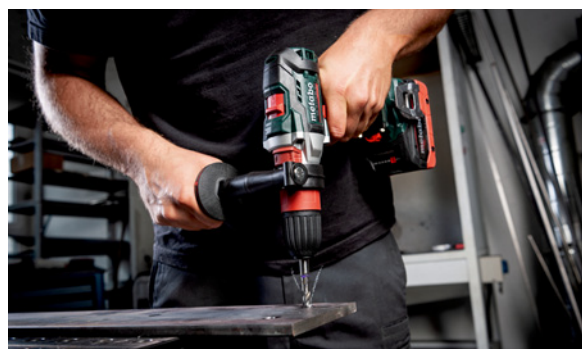
A nova máquina de abrir roscas sem fio GB 18 LTX BL Q I possui uma função de corte de roscas patenteada. Foto: Metabo
