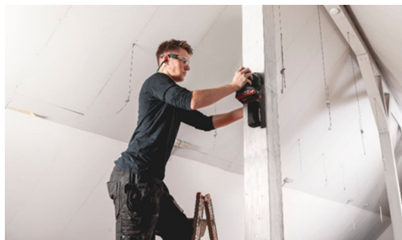
Lixar tinta velha ou alisar superfícies de madeira com primer: graças ao seu potente motor brushless, a nova lixadeira de disco orbital sem fio também é adequada para utilização contínua exigente. Foto: Metabo
