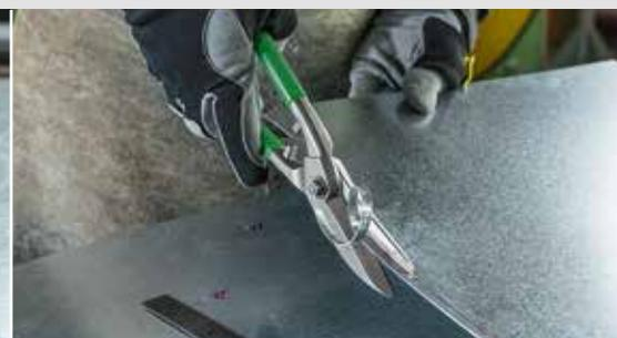
**Tesoura de punção com lâminas curvas**
