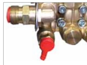
VÁLVULA TERMOSTÁTICA PARA PROTEGER A BOMBA DE ALTAS TEMPERATURAS NA FASE BY-PASS
