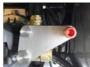
PLACA DE FIXAÇÃO METÁLICA PROTEGE A VÁLVULA BY-PASS DO ESFORÇO MECÂNICO
