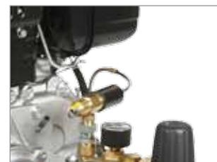
SISTEMA DE CONTROLO DO MOTOR PARA REDUÇÃO DAS RPM DURANTE A FASE BY-PASS
