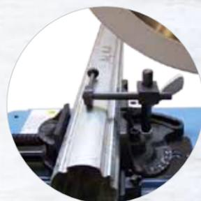
Ideal para corte de tubos de obturador com o sistema de fixação excêntrico
