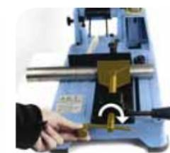
2. Fixar o material a cortar com o veio (uma única operação).
