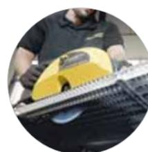
Ideal para corte de chapas metálicas, grades e painéis sanduíche até 67 mm
