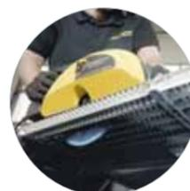
Ideal para corte de grelhas metálicas com lâmina de serra LBS anti-impacto
