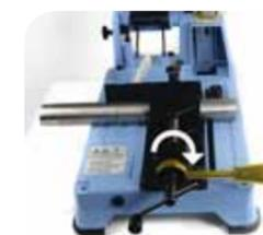
1. Posição inicial: Posicionar a alavanca de montagem rápida à direita.
