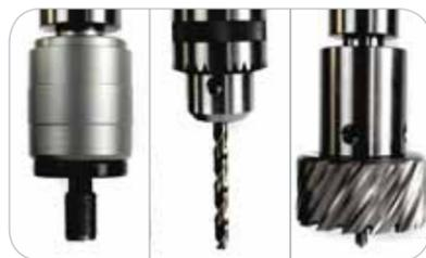
Abertura de roscas, perfuração com brocas helicoidais e fresas (podem ser necessários acessórios)
