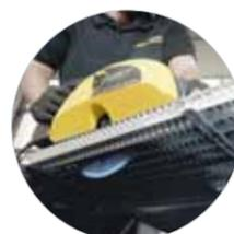
Ideal para corte de grelhas metálicas com a lâmina de serra LBS anti-impacto Ref.: 608295LBS
