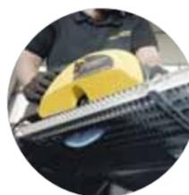
Ideal para corte de grelhas metálicas com lâminas de serra anti-impacto LBS
