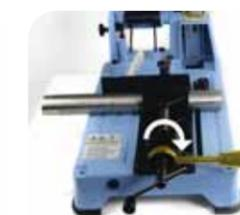
5. Rodar a alavanca para a direita e iniciar o corte; próximas etapas: 3 - 4 - 5.
