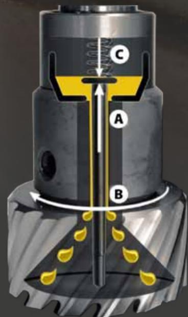
**A** Ao posicionar a fresa, o fornecimento de refrigerante é iniciado através do pino ejetor.
